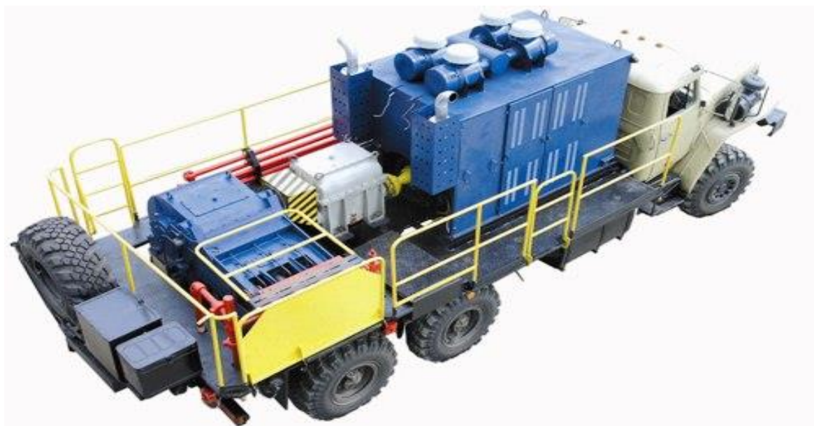
Рис. 3 – Насосный агрегат для ГРП 4АН-700: 1 - автомобиль КраЗ-257; 2 - кабина управления; 3 - силовой агрегат; 4 - коробка скоростей; 5 - муфта сцепления; 6 - насосный агрегат; 7 - выкидной маинфольд; 8 - соединительные трубы высокого давления
