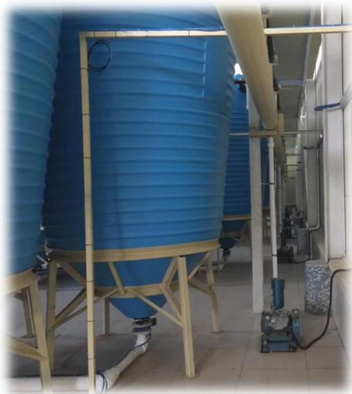
Рис. 3 – Биореактор с автоматизированной системой сброса осадка
