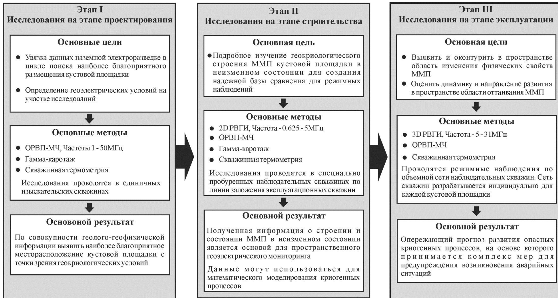
Рис. 6. Основные этапы пространственного геоэлектрического мониторинга скважинными методами
