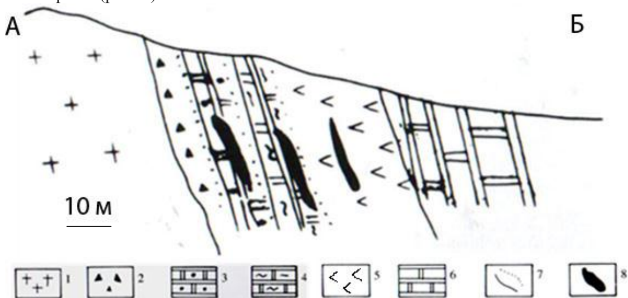
Рис. 6. Характерный геологический разрез по линии АБ нефритовой залежи района Хотен [Ян Хан Чэнь и др., 2012].
