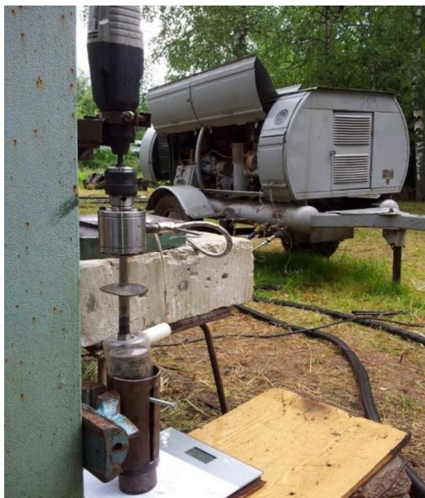
*Рис. 7. Снимок экспериментальной установки, при бурении с продувкой. Сергеево-Посадский научно-производственный полигон*
