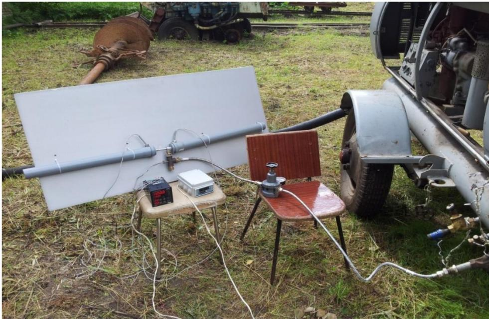
*Рис. 3. Фотография экспериментального стенда с вихревой трубой. Сергиево-Посадский научно-производственный полигон.*
