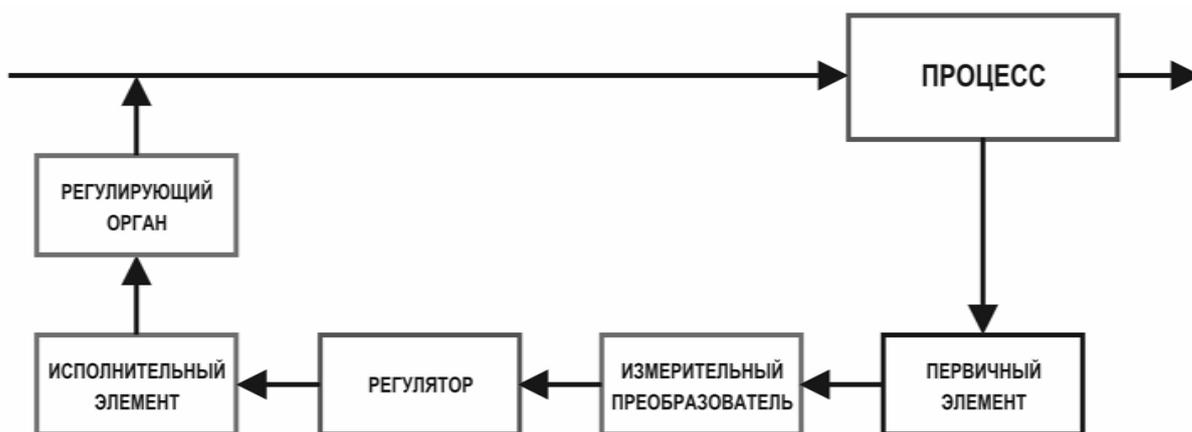
Рисунок 2.12 – Контур регулирования по отклонению с обратной связью
