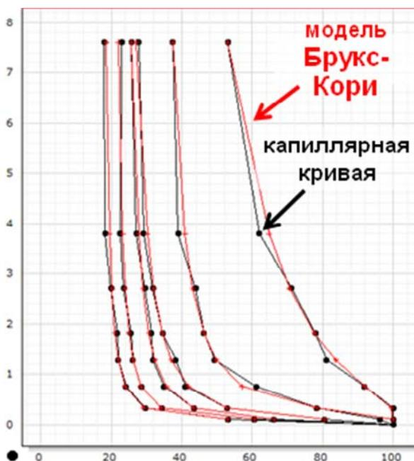
Рис.4 Аппроксимирование капиллярных кривых моделью Брукс-Кори
