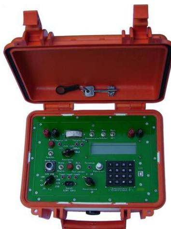
Рис. 2.6. Электроразведочный прибор Электротест С.
