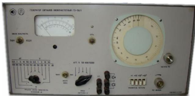
**Рис. 2.9. Генератор сигналов низкочастотный ГЗ-56/1.**
