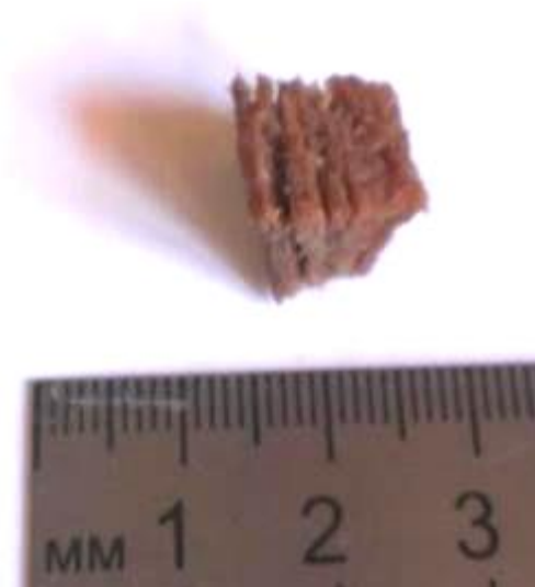
Рис 3.24. Фрагмент модели пласта из картона после продолжительного пребывания в воде
