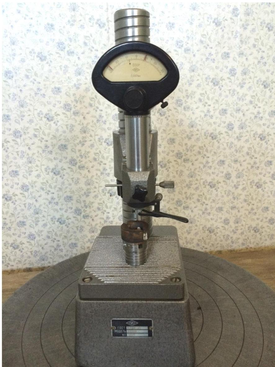
*Рис. 2.4. Микрометр модели 07201 для замера износа коронки по торцу.*
