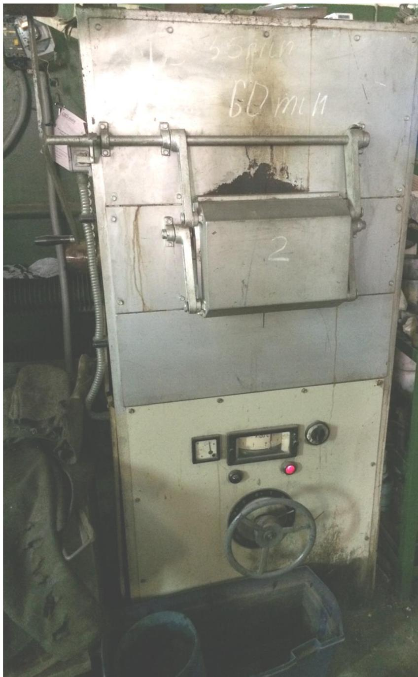
*Рис. 2.6. Термическая печь производства Германии KS 400/10*
