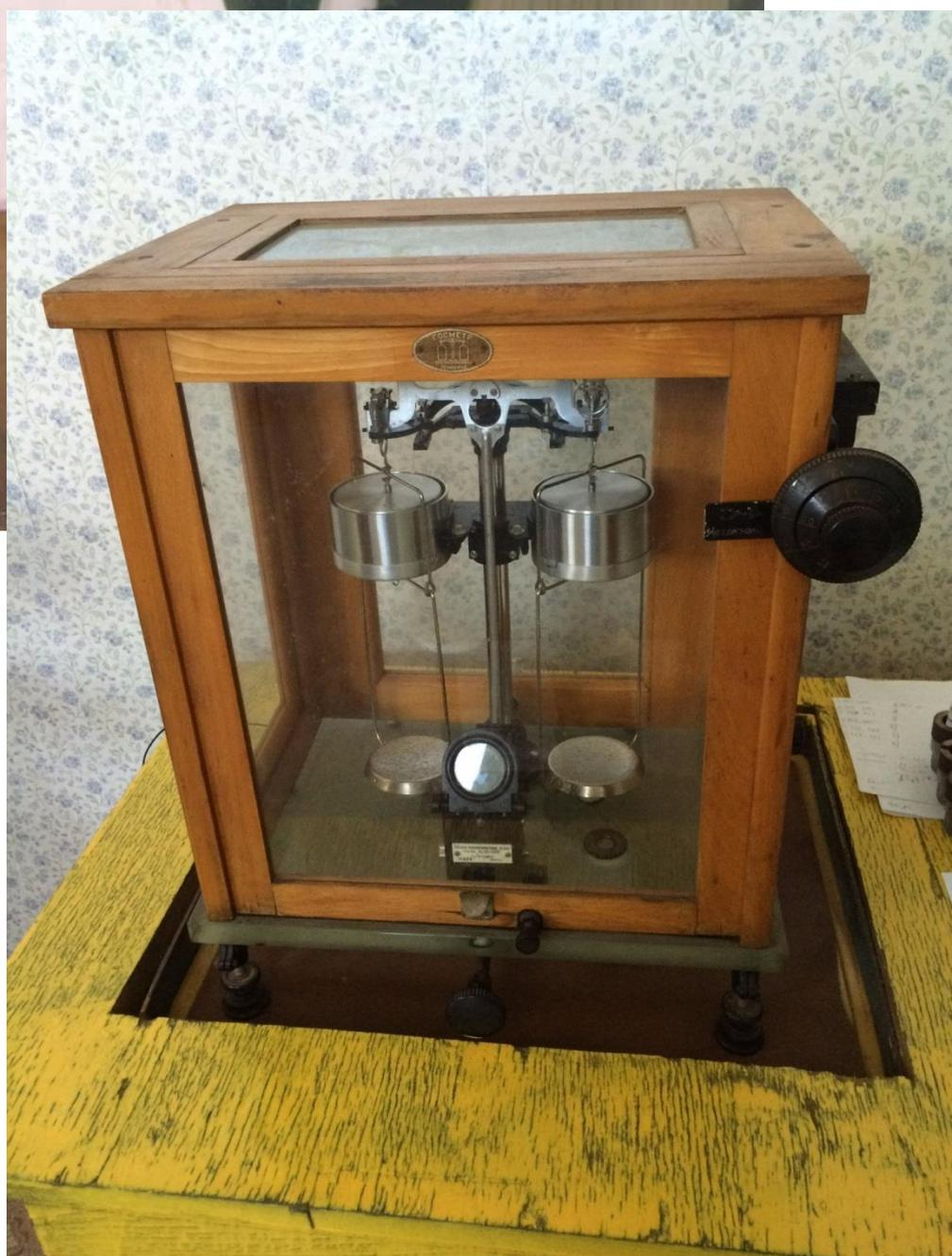
ие алмазного сырья и алмазных коронок диаметром 36 мм, а также потери массы дробы при определении абразивности пород производились на аналитических весах 2 класса точности марки АДВ-200 (рис.2.9).
