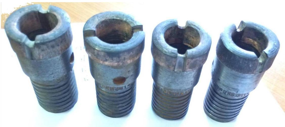
**Рис. 3.5. Коронки алмазные типа 02ИЗ-36**
