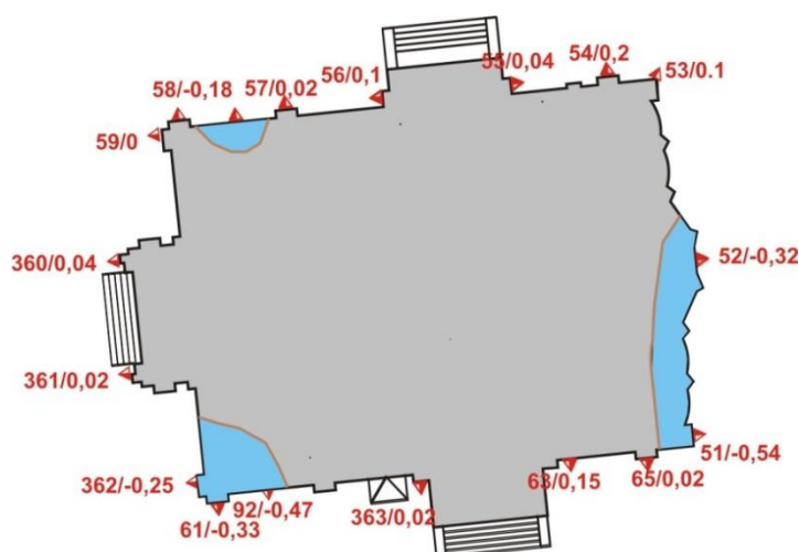
Рис. 12. Схема деформаций конструктивных элементов Успенского собора после укрепления основания
