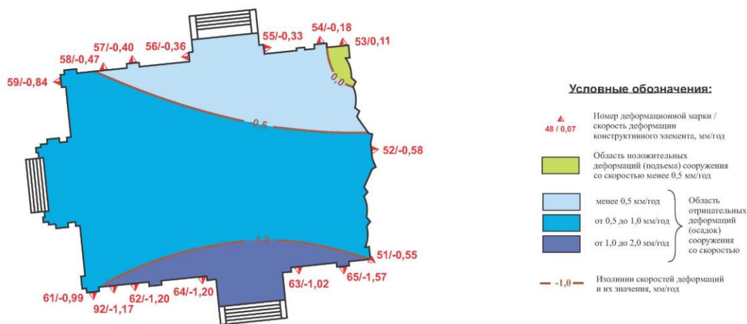
Рис. 11. Схема деформаций конструктивных элементов Успенского собора до укрепления основания
