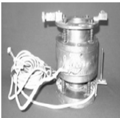
Рис. 4.19. Компрессионный прибор с измерением боковых напряжений конструкции МИСИ (Сидорчук, 1986) [10]
