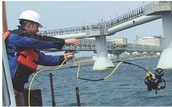
Рисунок 5.1.14. Опускание/сброс ROV с бортаплатформы
