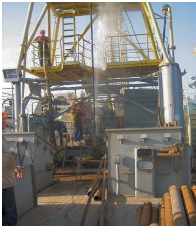
Рис. 4.2.1. Выброс водяной пульпы с метаном из обсадной колонны после отбора грунта на одном из месторождений Каспийского моря
