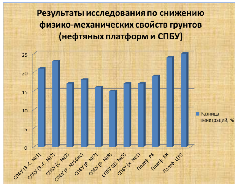
Рис. 4.2.14. Результаты исследования по снижению физико-механических свойств грунтов (под нефтяными платформами (МСП) и СПБУ)
