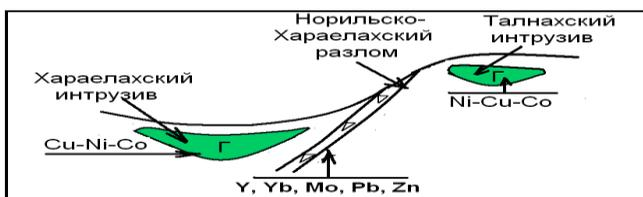
Рис. 16. Схематический геолого-геохимический разрез (поперечный) Талнахского рудного узла
