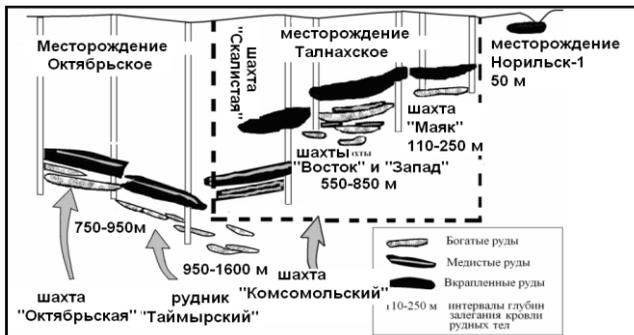
Рис. 20. Схематический разрез расположения рудных тел месторождений Норильского района (по данным рудничных геологов ПО «Норильскгеология»)
