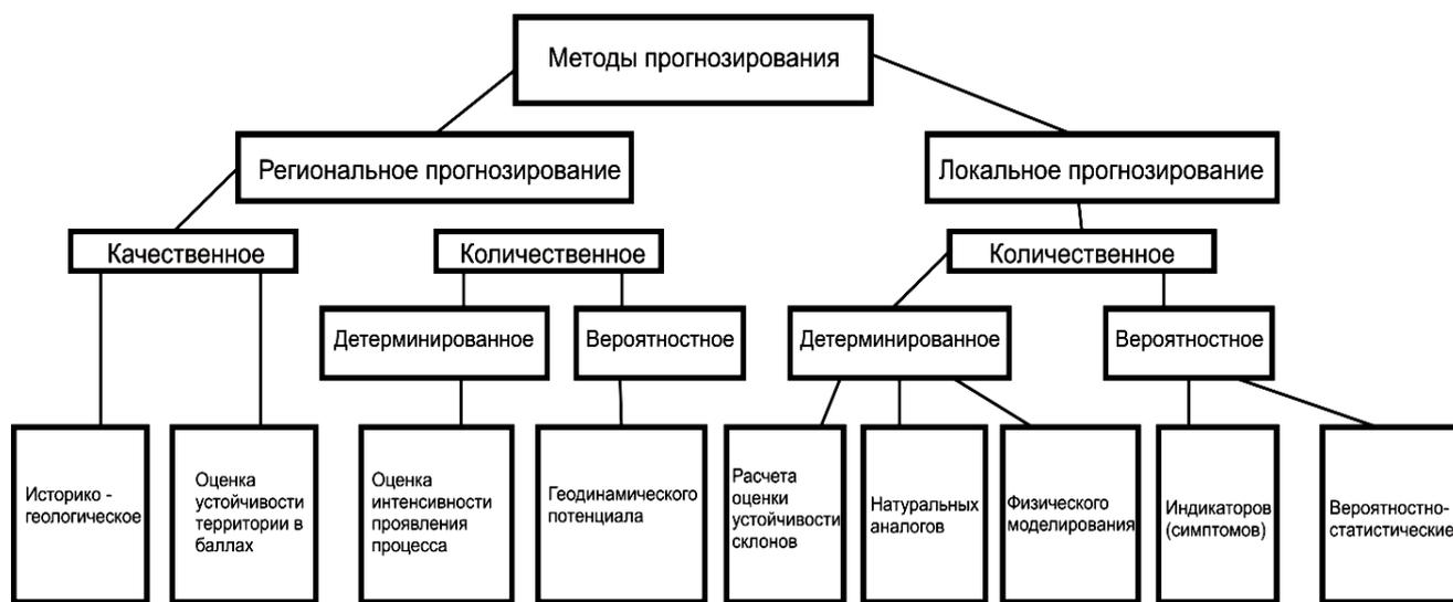
Рис. 1.4. Классификация методов прогнозирования оползневых процессов (по К.А. Гулакяну, В.В.Кюнтцелю и Г.П.Постоеву [14]).
