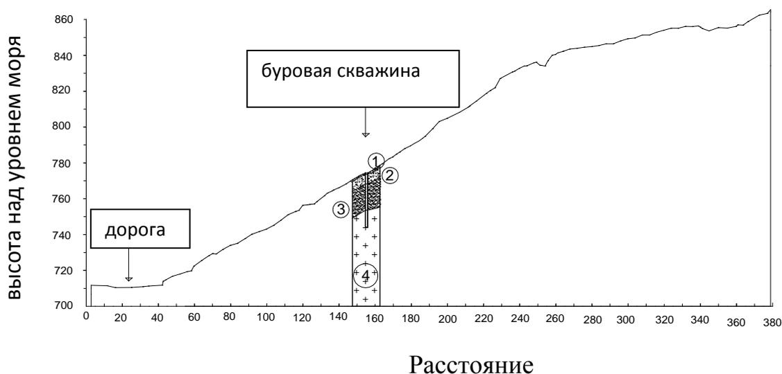
Рис 2.11. Геологический профиль через оползень в районе моста Монг Сен.
