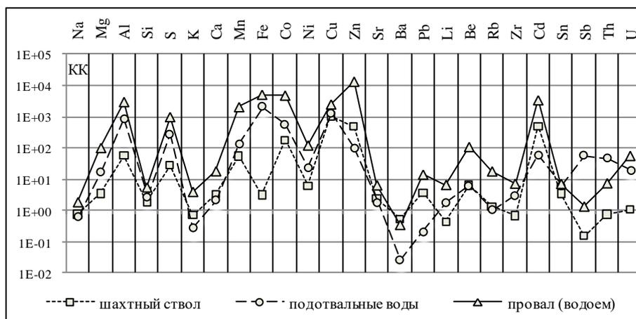
Рис. 8. Геохимический спектр макро- и микрокомпонентов в водных объектах Левихинского рудника (кларки концентраций)
