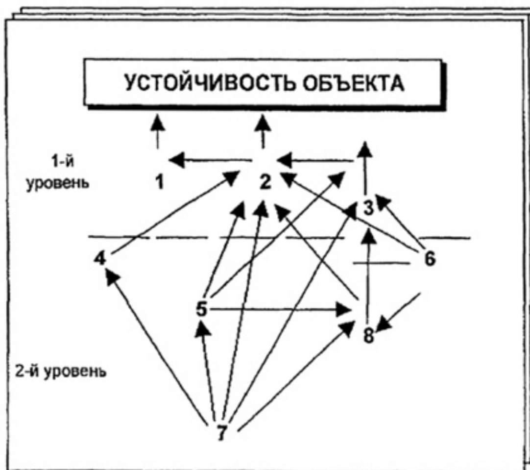
Рисунок 2. Граф трехмерной модели геологической среды. Базовые элементы модели, отражающие развитие и протекание геологических процессов: 1 — рельеф; 2 — состояние грунтовой толщи; 3 — уровень подземных вод; 4 — высотное положение кровли каменноугольных отложений; 5 — ее рельефность; 6 — литологический тип пород, залегающих в кровле каменноугольных толщ; 7 — наличие или отсутствие регионального юрского водоупора; 8 — наличие или отсутствие разуплотненных зон [Кофф Г. Л. 1999]
