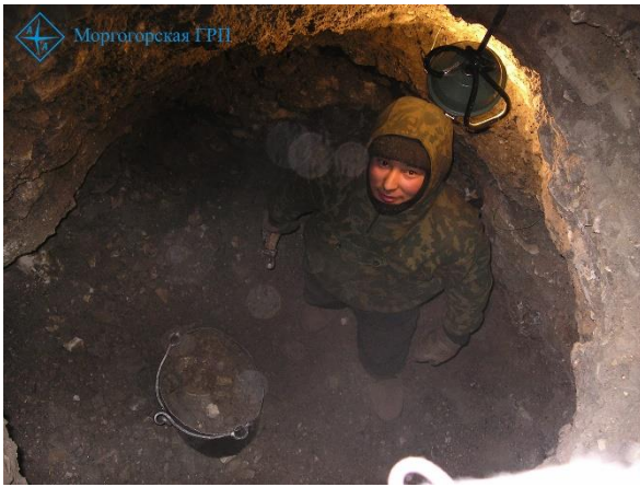
Рис.1.1. Ручной подъем породы из шурфа, на примере ОАО «Алмазы Анабара».
