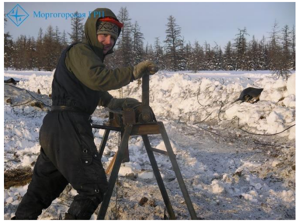
Рис.1.1. Ручной подъем породы из шурфа, на примере ОАО «Алмазы Анабара».
