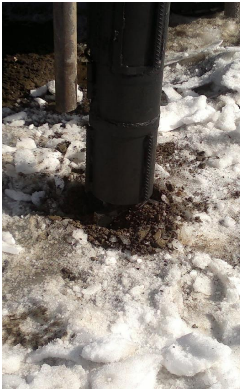
Рис.3.9. Бурение скважины опытным образцом бурового снаряда Ø170мм.
