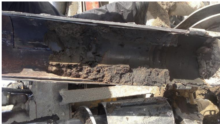
Рис. 3.15. Прилипшая к стенке трубы порода.
