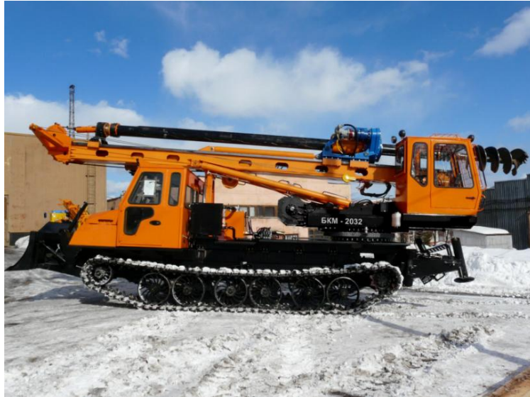
Рис.4.12. Буровая установка БKM-2032, на базе вездехода МТЧ-4
