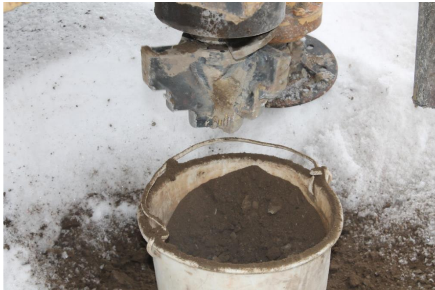
Рис.3.12. Извлечение пробы из опытного образца бурового снаряда.
