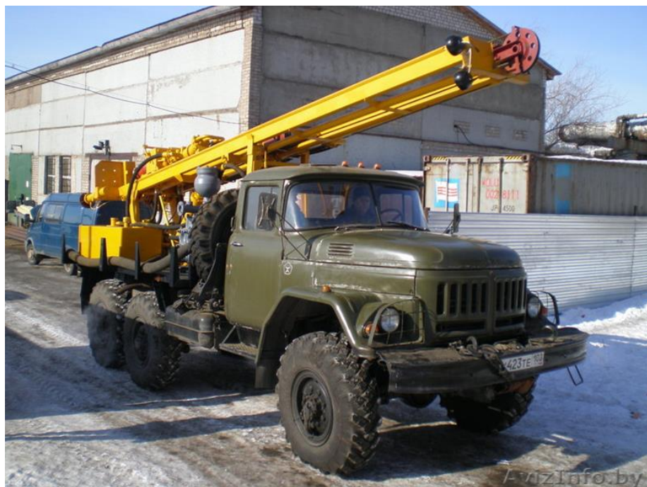
Рис. 3.1. Буровая установка УРБ-2А2.
