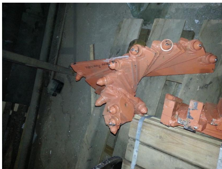
Рис.4.8. Бур конусно-скальный БТКК-Т, предназначен для бурения пород с IV по VI категории по буримости.
