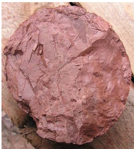
Рис. 13. Две системы крутопадающих трещин тектонического кливажа в красноцветных алевроаргиллитах лессовидного облика. Штуф из скв. Б13, глубина 211 м.
