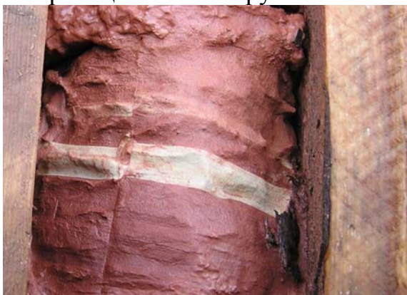
Рис. 12. Микросбросо-взброс с амплитудой 1 см в осветленных аргиллитах венда. Штуф из скв. Б-15 глубина 80 м.
