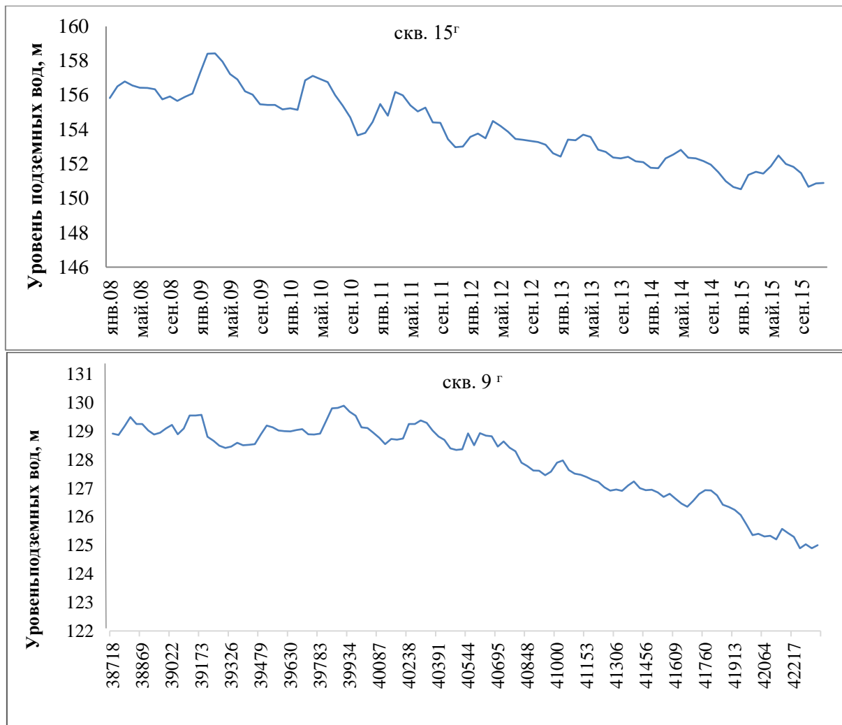
Рис. 3. Графики изменения уровней подземных вод альб-сеноманского (скважина 9 г ) и турон-коньякского (скважина 15 г ) водоносных горизонтов (2006–2015 гг.)
