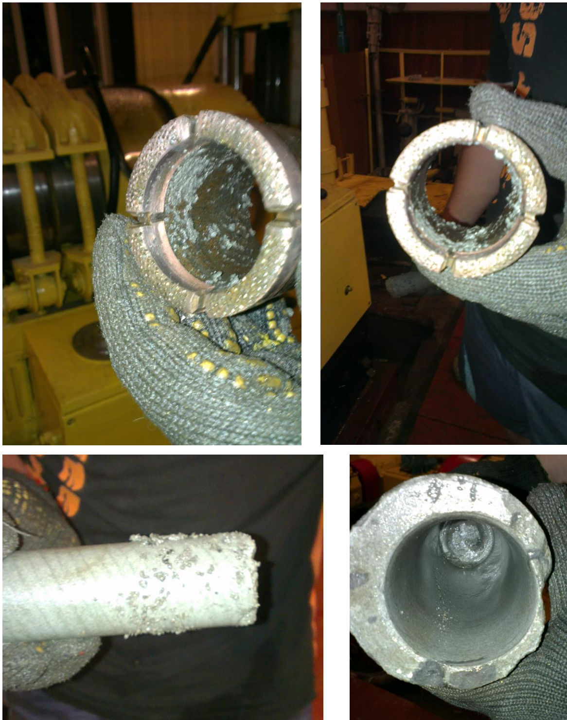
Рисунок 4.3 – Фото результатов экспериментального бурения однослойной алмазной коронкой, армированной крупным монокристаллом (факт наличия шлама)
