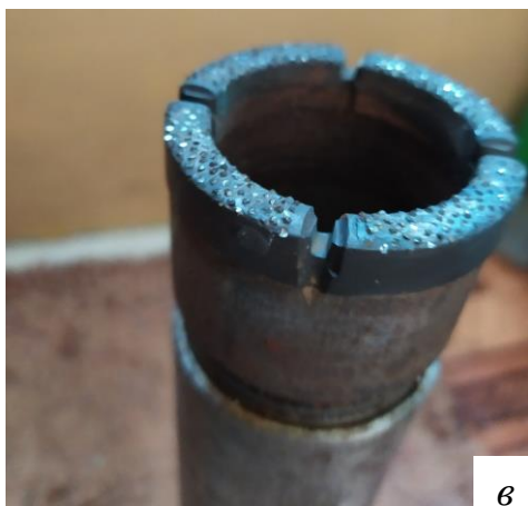
Рисунок 4.2 – Испытуемая коронка: а – пуансон; б – опытные образцы; в – фото перед сборкой; г – раскладка алмазов в секторе
