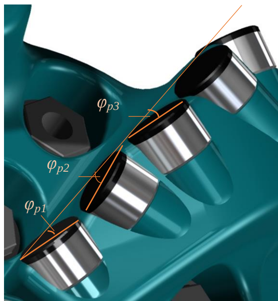
Рисунок 6.19 – Размещение резцов PDC на одной лопасти долота Ulterro : \varphi_{p1} – фронтальный угол первого резца; \varphi_{p2} – фронтальный угол второго резца; \varphi_{p3} – фронтальный угол третьего резца
