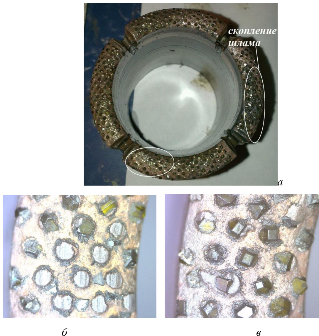
Рисунок 3.30 – Торец рабочей части алмазной однослойной коронки армированной алмазами марки АС: а – фото торца коронки после бурения; б – фото набегающей части сектора; в – фото сбегающей части того же сектора [130]
