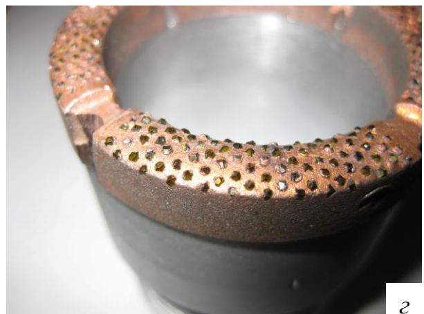
Рисунок 4.2 – Испытуемая коронка: а – пуансон; б – опытные образцы; в – фото перед сборкой; г – раскладка алмазов в секторе
