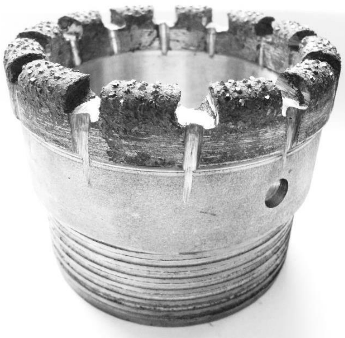
Рисунок 6.3 – Фото опытного образца коронки БСО-1
