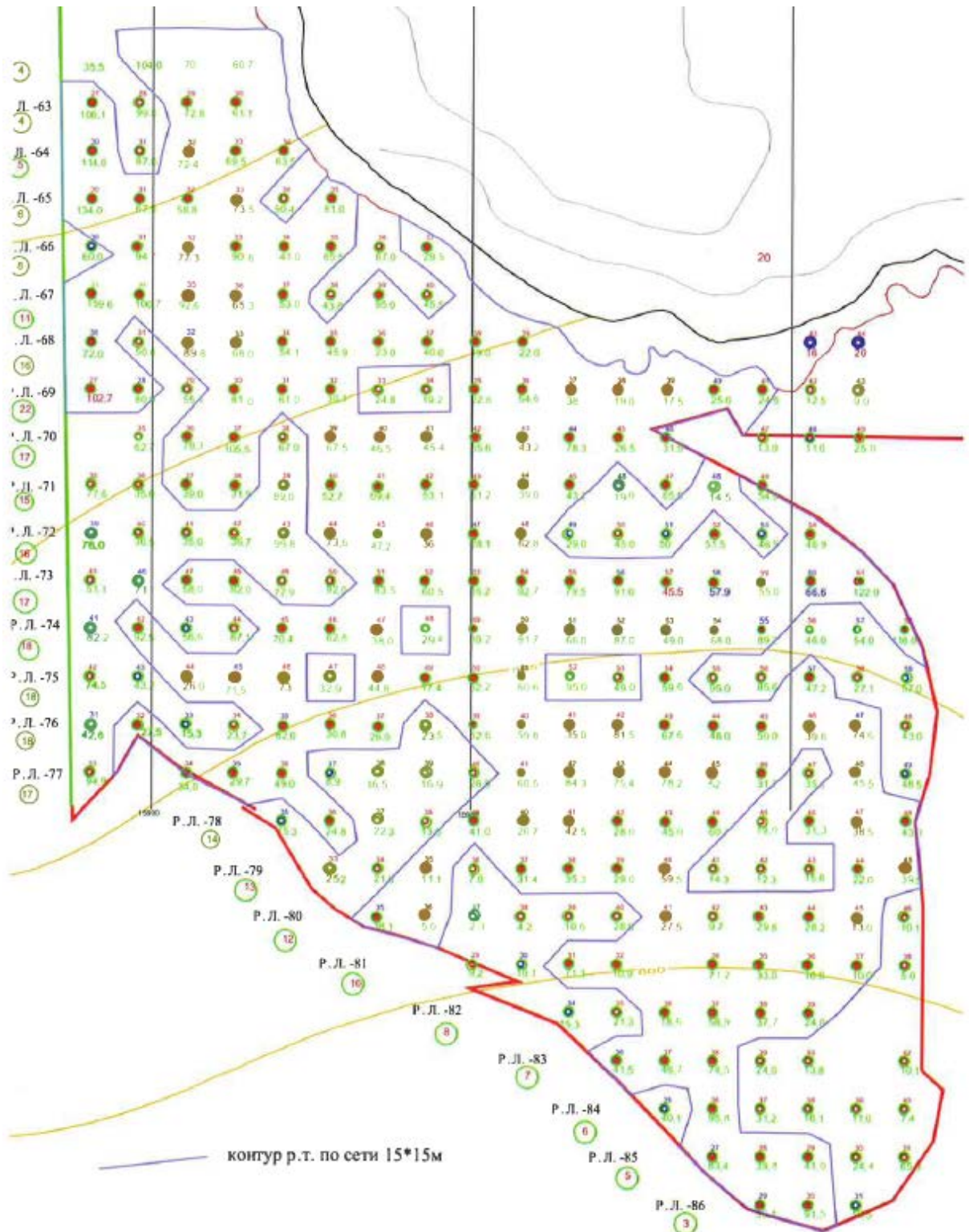
Рисунок 4.10 – План участка детализации с контурами (синий цвет) рудных тел в проекции на горизонтальную плоскость
