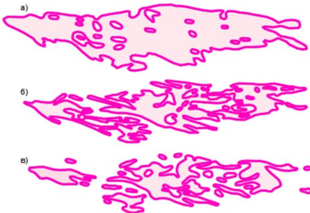
Рисунок 2.7 – Морфология рудных тел при оконтуривании по разным (а, б, в) бортовым содержаниям (по В.А. Викентьеву и др. [12])
