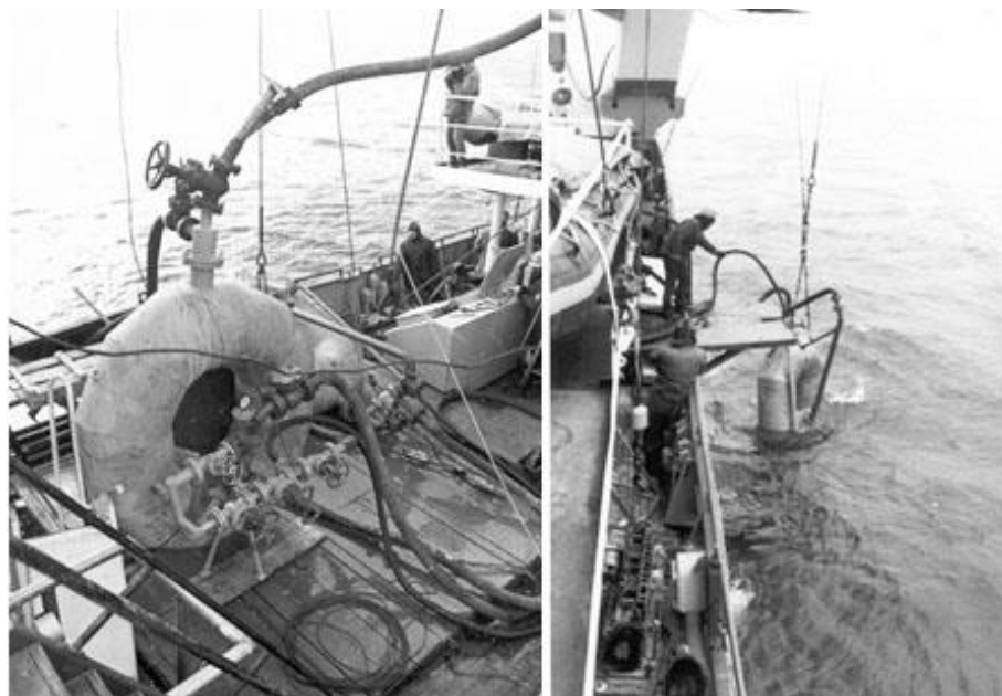
Рис.3. Морские испытания загрузочных аппаратов с использованием энергии закрученных струй на НИС «Полигон» на акватории Черного моря (г. Новороссийск): а – палубная загрузочно-обменная емкость торообразной формы; б – донная загрузочно-обменная емкость.
