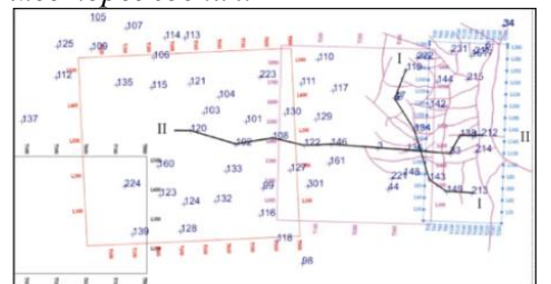
Рисунок 7. Схема расположения сейсмических профилей и скважин на Северо-Покачевском месторождении.
