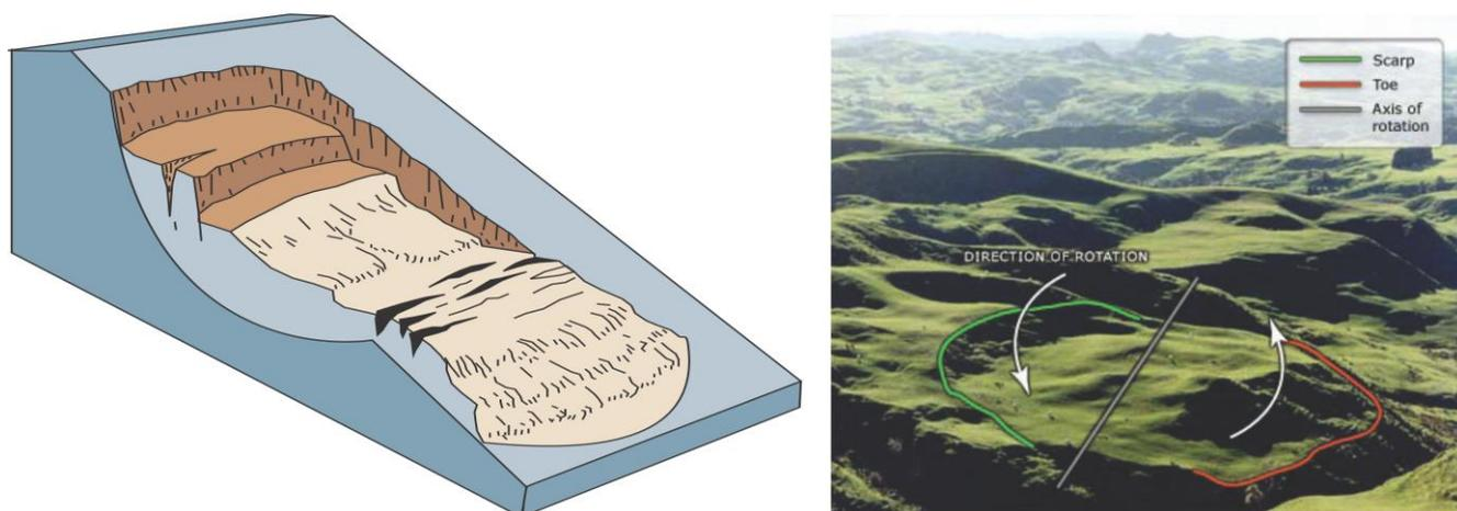
Рисунок 1.6 – Схема и фотография оползня вращения
