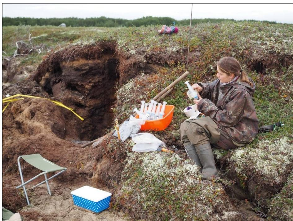
Рисунок 4.1 – Отбор образцов методом “Headspace” из береговой зачистки полигонального торфяника на острове Кашин
