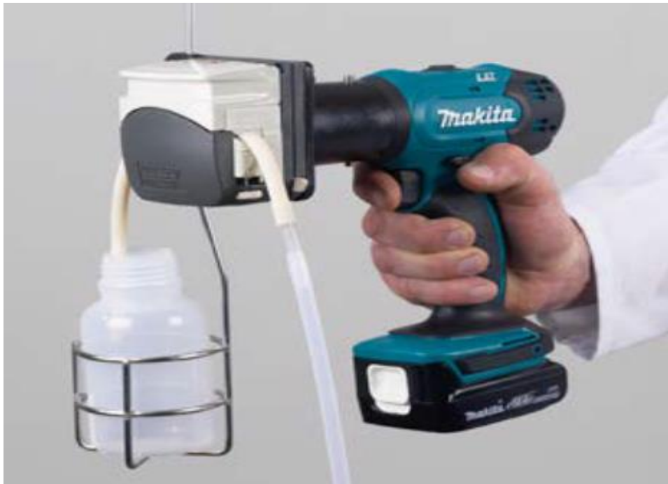
Рисунок 2. Отбор проб пробоотборником Vampire фирмы «Burkle»
