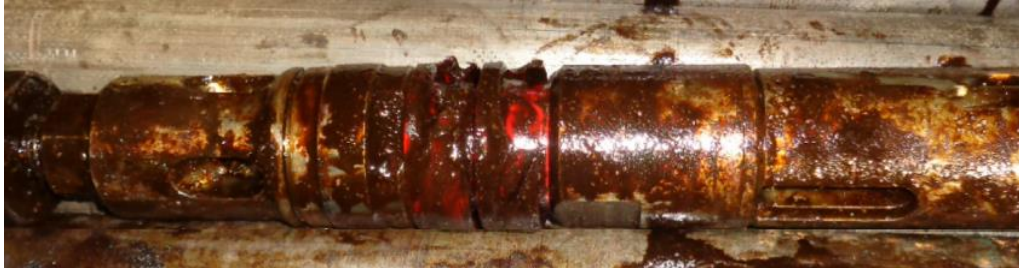
Рисунок 3. Головная часть керноприемника. Манжеты (красного цвета) порваны.
