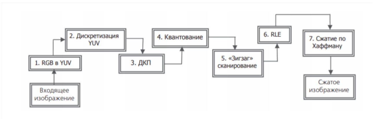
Рисунок 1. Последовательность этапов при сжатии изображения алгоритмом JPEG
