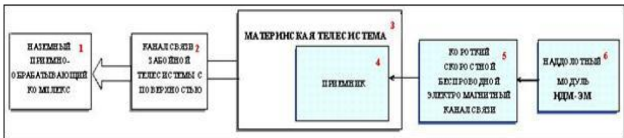
Рисунок 1. Структурная схема телесистемы с наддолотным модулем.
