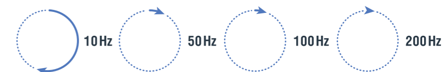
РИСУНОК 3. Угловое смещение буровой колонны при различных частотах дискретизации
