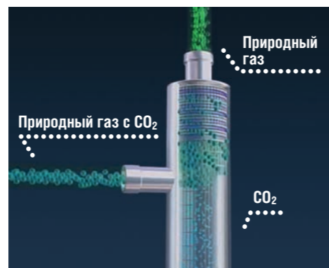
РИС. 4. Отделение ПНГ от углекислого газа
