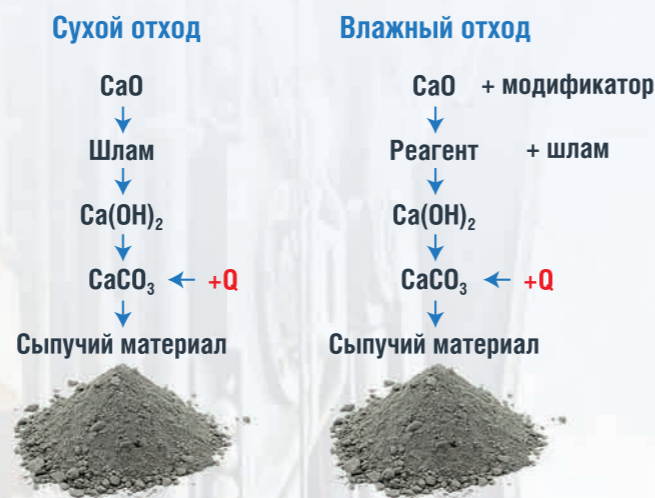
РИС. 3. Разница процессов введения реагентной добавки для сухого и влажного отходов
