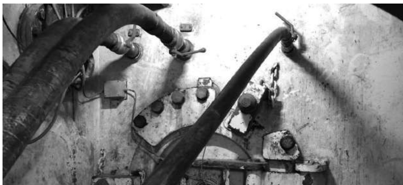
Рис. 1. Каналы для подачи полимера и бентонита в камеру ротора.
